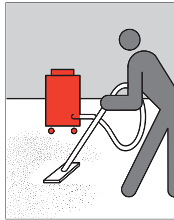
Bild 10: Staub entfernen durch Saugen.
